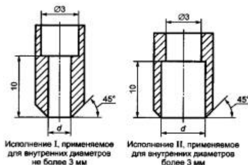
Рисунок Г.2 - Насадки, применяемые для пузырькового метода контроля герметичности затвора (пробное вещество - воздух)
